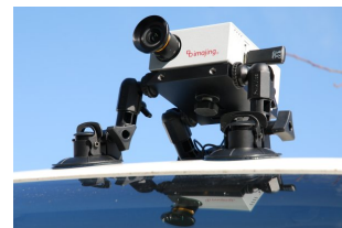
FIGURE 1 – L'imajbox : système d'acquisition mobile pour le relevé de réseaux de transport.
