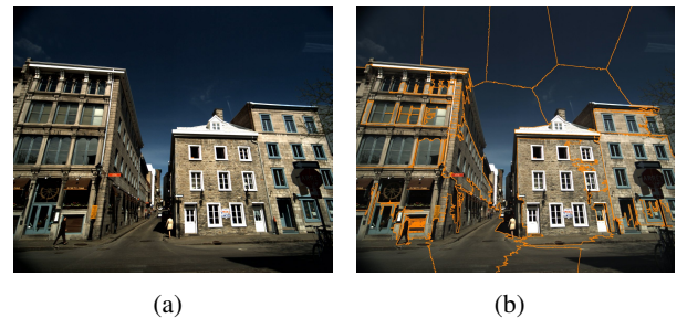
FIGURE 4 – (a) Image originale ( 2448 \times 2050 ). (b) Image segmentée en utilisant les superpixels [1] avec les paramètres K = 20 , c = 20 , cf. § 2.1 pour plus de détails.
